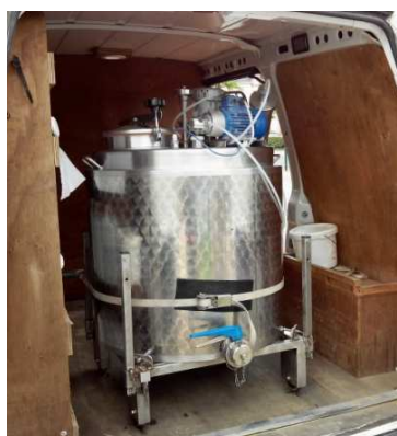
Figure 3: Tank de 200 L utilisé pour le distributeur de lait
